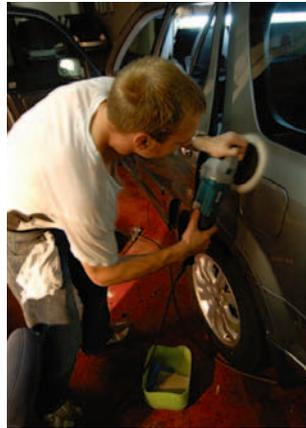
▲ ...deshalb wird die Oberfläche maschinell poliert
